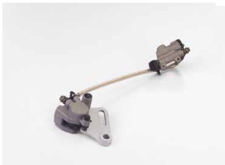
KOMPLETNÍ ZADNÍ BRZDA JEDNOPÍSTOVÁ COMPLETE REAR BRAKE ASSEMBLY
